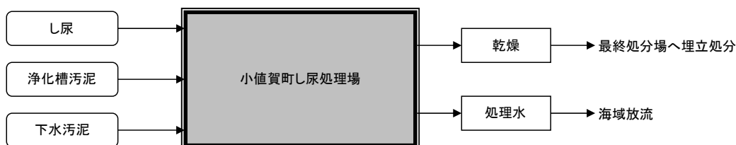
図 2-1-2 現状のし尿処理フロー
