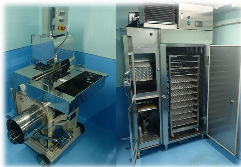
水産加工施設に整備された魚肉採取機(左)、燻製機(右)
